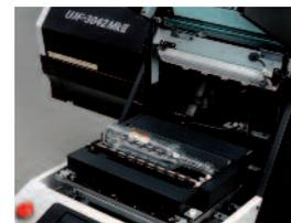
Eine verbesserte Mechanik mit einem sich während des Druckvorgangs bewegenden Drucktisch verringert Schwingungen. Ausserdem werden so eine exakte Platzierung der Tintentröpfchen und ein qualitativ hochwertiger Druck auf einer Vielzahl von Objekten und Materialien sichergestellt.
