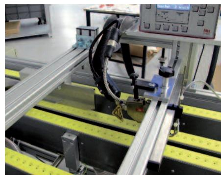
Das Vakuumband ist mit einem Pflugfalz sowie Heissleimsystem ausgestattet und kann um weitere Module erweitert werden.
