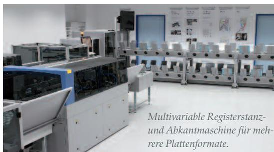
Multivariable Registerstanz- und Abkantmaschine für mehrere Plattenformate.
