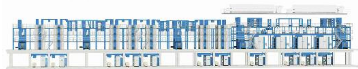
Ansicht der zwei neuen Cortina-Sektionen und der KBA Commander nach dem Retrofit.
