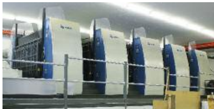
Mit der KBA Rapida 205 Bogenoffsetmaschine werden Plakate bis zum Druckformat von 205 x 150 cm hergestellt.
