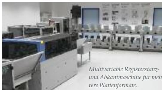
Multivariable Registerstanz- und Abkantmaschine für mehrere Plattenformate.
