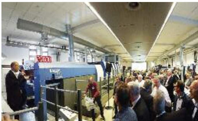
Haftpapier mit 80 g/m 2 wurde über den Rollenschneider an einer Rapida 106 im LED-UV bedruckt – bei Leistungen von 20.000 Bogen/h.
