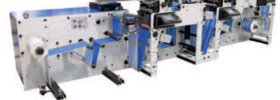
zu 50 m/Min. aus einer Blankrolle fertige Etiketten auf Rolle oder Bogen. Mit einem zweiten Flexowerk kann das Material mit Coating optimiert werden.
