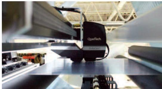
Durch präzise Inline-Farbmessungen reduziert DeltaCam von QuadTech die Makulatur und sorgt für Druck-Erzeugnisse, die die Farbvorgaben des Kunden einhalten.
