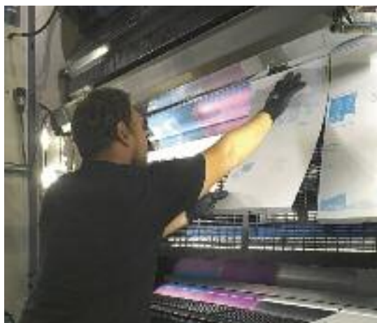
Drucker Erasmus Gläfel beim Einhängen von Libra VP Platten an einem Plattenzylinder der im Jahr 2013 in Betrieb genommenen Zeitungsrotation.
