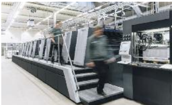
Die Speedmaster XL 106-Zehnfarben mit Wendung ist weltweit die erste Maschine, die den Farbwerksantrieb Hycolor Multidrive in Teilausstattung enthält.
