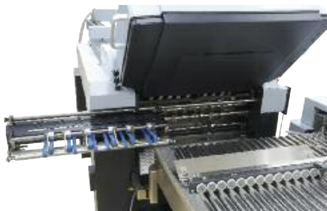
Mit nur einem Knopfdruck wird selbst bei komplexen Falzungen die präzise Positionierung der Rillwerkzeuge ermöglicht.
