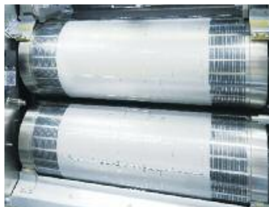
Die RD-4055DM Stanzmaschine von Horizon ist serienmässig mit zwei Magnetzylindern ausgestattet.
