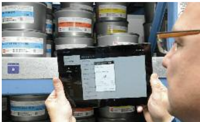
Lagerplatz mit NFC-Tag, erfassen der Farbmenge im Lager mit der ProductionApp und Einscannen des Chargencodes der Farbe direkt am Verbrauchsort, das heißt an dem Druckwerk, an dem es zum Einsatz kommt.
