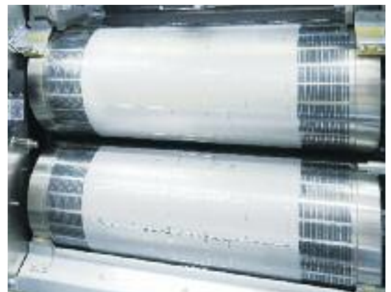
Die RD-4055DM Stanzmaschine von Horizon ist serienmäßig mit zwei Magnetzylindern ausgestattet.
