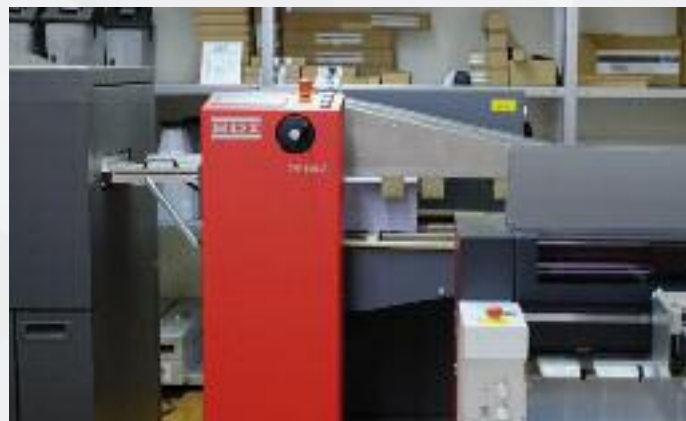
Mit dem Langformatanleger können auf der Nexpress ZX3300 Bogen bis zu einem Format von 356 x 1.000 mm bedruckt werden.
