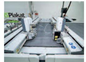
Der D3 ist mit zwei Balken ausgestattet, an die jeweils bis zu drei unterschiedliche Werkzeugmodule montiert werden können.
