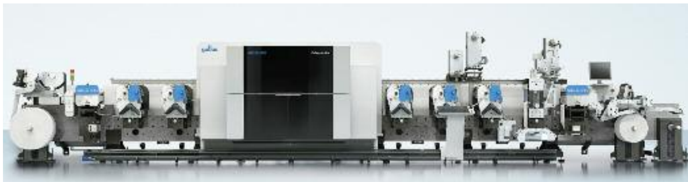
Die Gallus Labelfire bei Insignis verfügt über erweiterte Inline-Veredelungsprozesse, wie zum Beispiel Kaltfolien- und Siebdruck.
