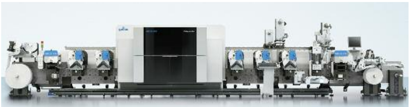
Die Gallus Labelfire bei Insignis verfügt über erweiterte Inline-Veredelungsprozesse, wie zum Beispiel Kaltfolien- und Siebdruck.
