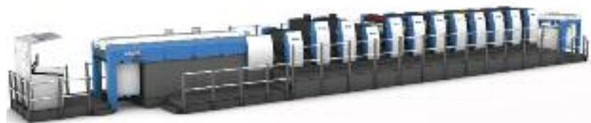
Rapida 106 mit insgesamt 12 High-Tech-Werken (8 Druck-, 2 Lack-, 2 Trockenwerke).
