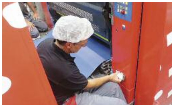
Gummituchwechsel an einer Rapida 145: Das Tuch ist per App an dem Druckwerk, an dem es zum Einsatz kommt, erfasst und seine Standzeit lässt sich exakt verfolgen und planen.
