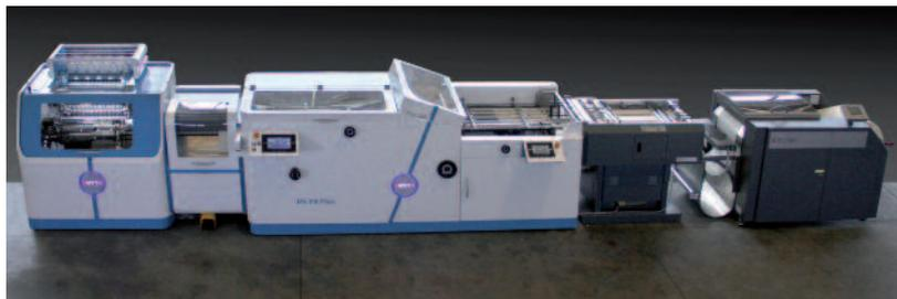
*Tecna und Smyth bringen eine neue Falz- und Fadenheftlösung für die Rollenverarbeitung von Digitaldruckprodukten auf den Markt.*
