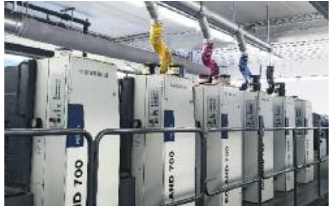
Die Absaugung erfolgt direkt am Walzenstuhl. Die Nebelpartikel werden über eine Rohgassammelleitung mit hoher Geschwindigkeit weggetragen.
