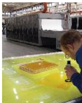
Visuelle Kontrolle einer fertig verarbeiteten Flexcel NX Platte.
