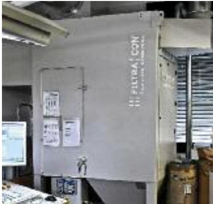
Die Reise des Farbnebels endet in einem Patronenfilterelement und dem Staubsammelbehälter.
