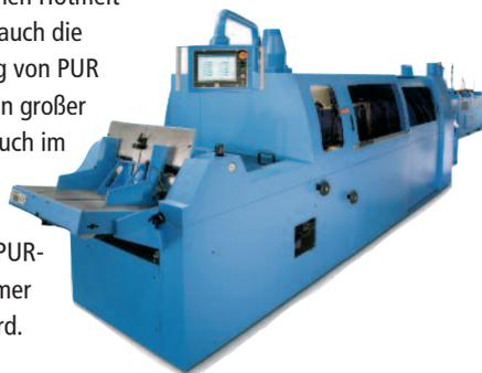
Ausfahrbare Leimwagen erleichtern bei Produktionsumstellungen den Leimwechsel. Als Alternative zum Leimbecken bietet Müller Martini die VPN-Buchrückendüse an. Sie trägt den PUR-Klebstoff sparsam mit konstanter, minimaler Dicke auf.
