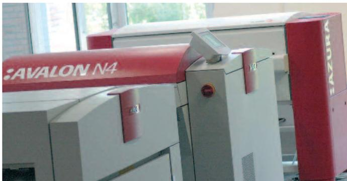
der chemiefreien Azura-Druckplatten arbeiten. Sowohl die Azura als auch die Azura TS basieren auf der Thermofuse-Technologie von Agfa, bei der auf dem Aluminium-Träger eine Schicht aus feinen Latexpartikeln aufgebracht ist, die mit thermischer Energie geschmolzen werden.
