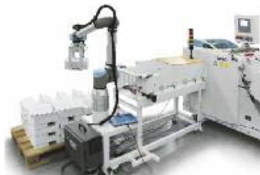
Der kollaborierende Roboter (Cobot) MBO CoBo-Stack setzt Produktstapel auf Paletten ab und entlastet dadurch den Bediener körperlich. Damit wird das Abstapeln in der Weiterverarbeitung neu organisiert.
