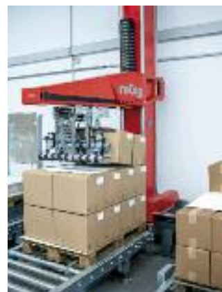
Ein Palettierroboter verschließt, etikettiert, palettiert und transportiert die verpackten Ware.
