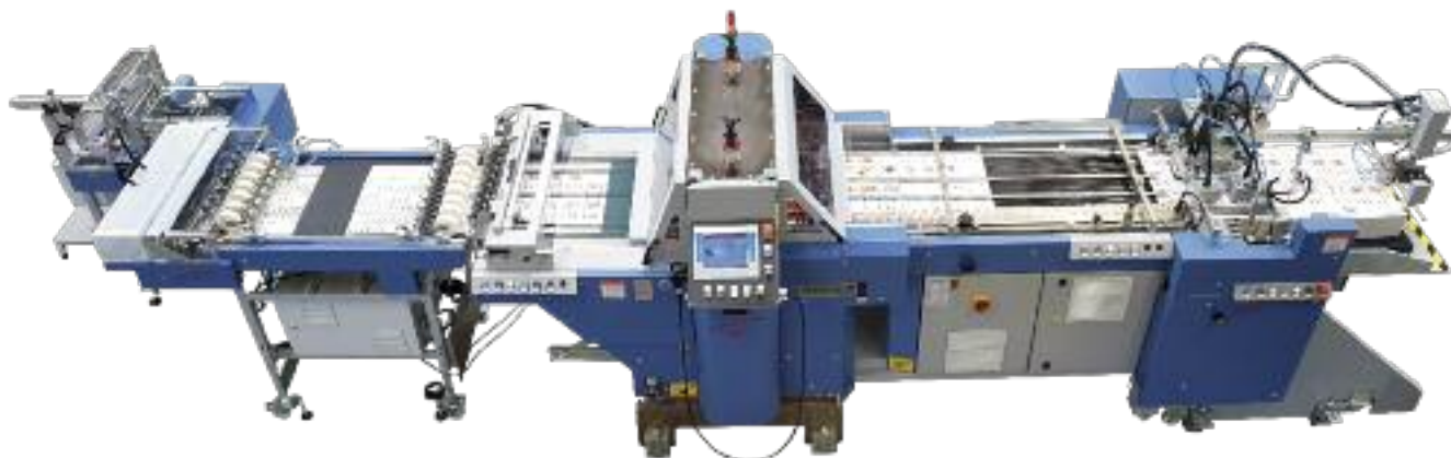
Das System von Bograma für die Spielkartenproduktion ermöglicht Stanzen, Ausbrechen und Schuppen der Druckbogen, automatisierte Stapelbildung zum kompletten Deck und die Weiterführung zum Sammelschacht via Transportband.
