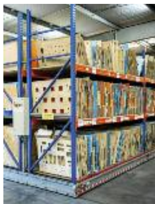
Enormes Kapital: Mehr als 4.500 Stanzwerkzeuge sind in einem automatischen Lager jederzeit für die Produktion verfügbar.
