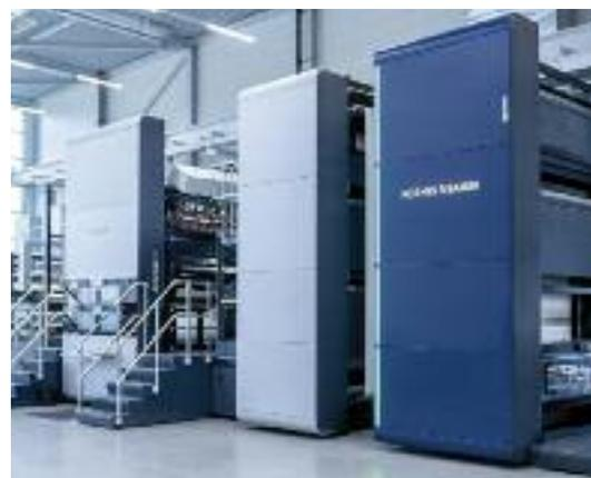
Beispielhaftes Bild einer RotaJet für den digitalen Dekordruck.
