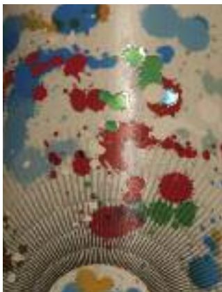
Banderole im 7c Digitaldruck mit überdruckter Kallsiegelfolie, digitalem Metallic Doming Effekt sowie flächigem Mattlack mit Soft Touch Effekt.
