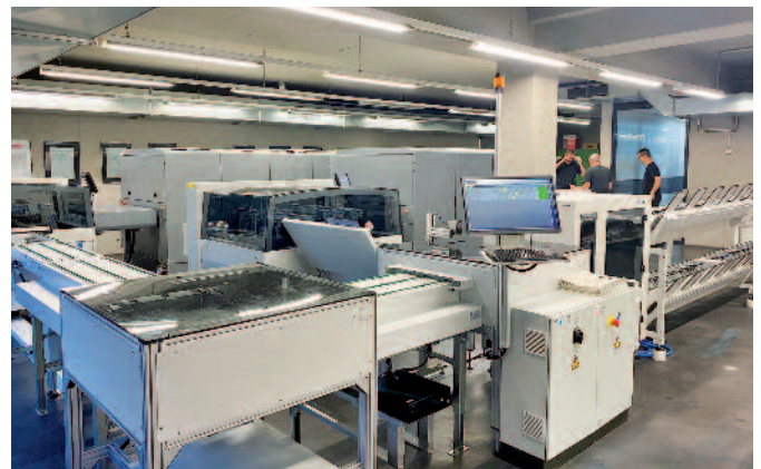
Der Wechsel zur prozessfreien Platte von Kodak ermöglichte eine neue Anordnung der Plattenbelichter sowie der Registerstanz- und Abkantsysteme und der Plattensortieranlage.
