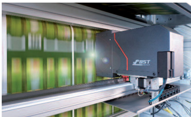
Das Monitoringsystem BST ProView soll im Druckprozess maximale Qualität bei moderatem Preis gewährleisten. Das System zur Video-Bahnüberwachung ermöglicht selbst bei einer maximalen Bahngeschwindigkeit von 1.000 m/Min. eine zuverlässige Druckbildkontrolle.
