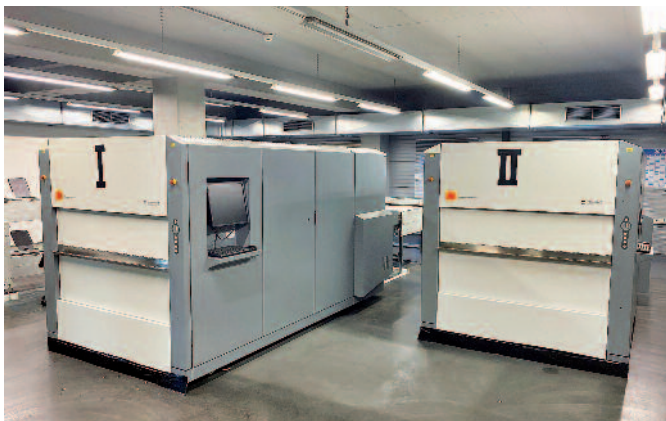
Auf zwei neu installierten Kodak Generation News Plattenbelichtern bebildert die Zeitungsdruckerei die prozessfreie Kodak Sonora Xtra Platte.
