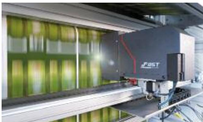
Das Monitoringssystem *BST ProView* soll im Druckprozess maximale Qualität bei moderatem Preis gewährleisten. Das System zur Video-Bahnüberwachung ermöglicht selbst bei einer maximalen Bahngeschwindigkeit von 1.000 m/Min. eine zuverlässige Druckbildkontrolle.
