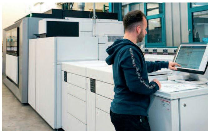
Die bei *Esser printSolutions* installierte *varioPRINT iX* bietet eine hohe Druckgeschwindigkeit von 320 A4-Seiten pro Minute (19.200 Bg/h) und verarbeitet Bogen bis zum sogenannten B3-Format (350 x 508 mm).
