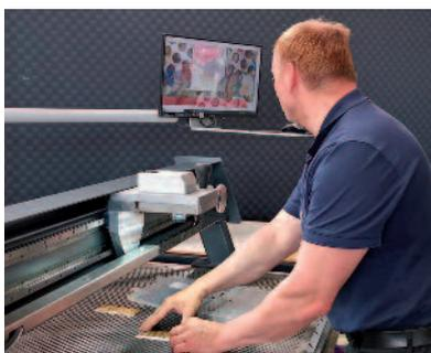
Auch das »Auswalzen« des Druckbogens wird in die Referenzdaten einbezogen, sodass die Klischees im kamerabasierten Abgleich zum Bildschirm direkt auf die Zielposition montiert werden können. Kein Ausmessen, kein Ausschneiden, keine Nachkorrekturen an der heißen Platte und so gut wie keine Makulatur verspricht der Hersteller. Und Bediener hätten das Positioniersystem mit der intuitiven Benutzerführung schnell im Griff.
