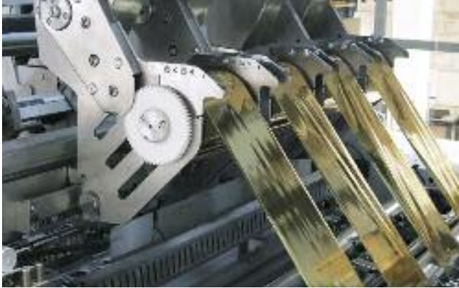
Mit der NovaFoil 106 werden bei der Offsetdruckerei Schwarzach große Auflagen von Verpackungen hergestellt, bei denen größere Flächen zu veredeln sind.
