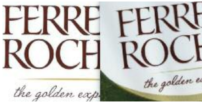
Vergleich der Wiedergabe von Text im Flexodruck mit Flexcel NX Platten und Impulse Screen (links) und im Tiefdruck (rechts).
