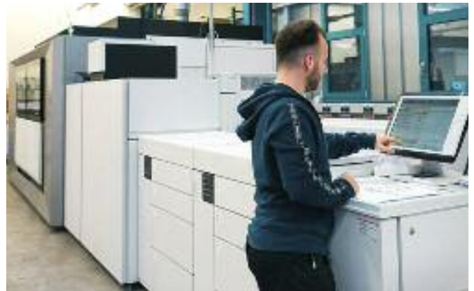
Die bei Esser printSolutions installierte varioPRINT iX bietet eine hohe Druckgeschwindigkeit von 320 A4-Seiten pro Minute (19.200 Bg/h) und verarbeitet Bogen bis zum sogenannten B3-Format (350 x 508 mm).
