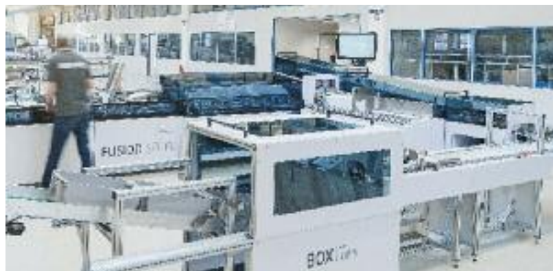
Bowe Systec integriert in sein Konzept aktueller Kuvertiersysteme vor- und nachgelagerte Prozesse im Mailroom in eine durchgängige Automatisierung.
