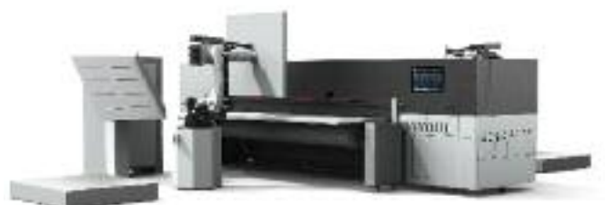
Im Zentrum von P5 Robotics steht das P5 350 HS D4 Hybrid -Drucksystem, dessen Feeder-/Stackereinheit zwei Kuka -Roboter bilden, um die mannlose Produktion einer
