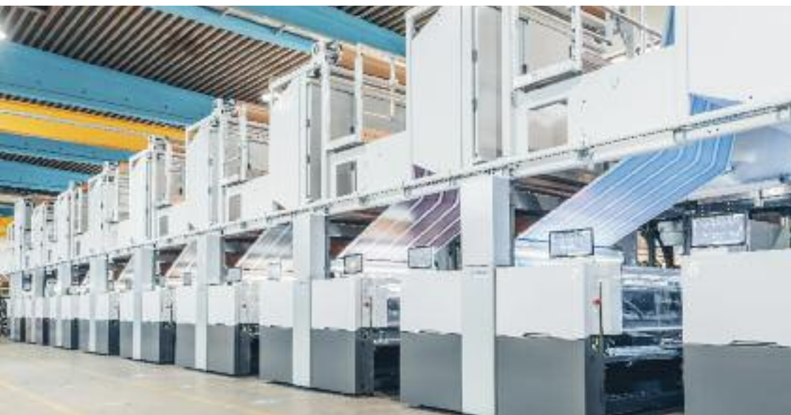
Die Heidelberg Boardmaster erlaubt durch den modulartigen Aufbau Anpassungen.
