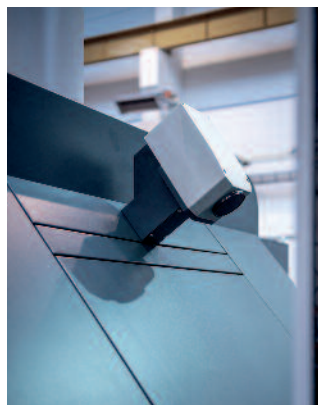
Die Kamera des QualiTronic ColorControl (Bild links) misst jeden Bogen und regelt jeden 10. Bogen. Die ziehmarkenfreie Anlage DriveTronic SIS arbeitet hochpräzise und ist eines der Unique Selling Points der Rapida 76.
