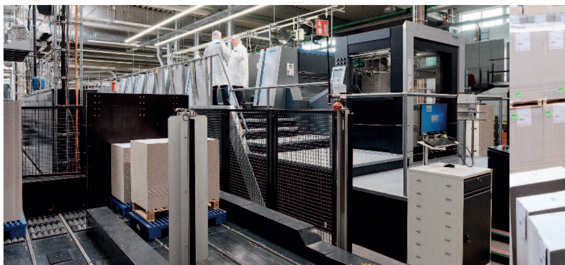
Weig Packaging hat seine Kapazitäten durch eine Speedmaster XL 106 21k , die erste Maschine der 21.000er-Generation in Deutschland, verstärkt. Die hochgesetzte Bogenoffsetmaschine ist mit vollautomatischer Palettenlogistik ausgerüstet.
