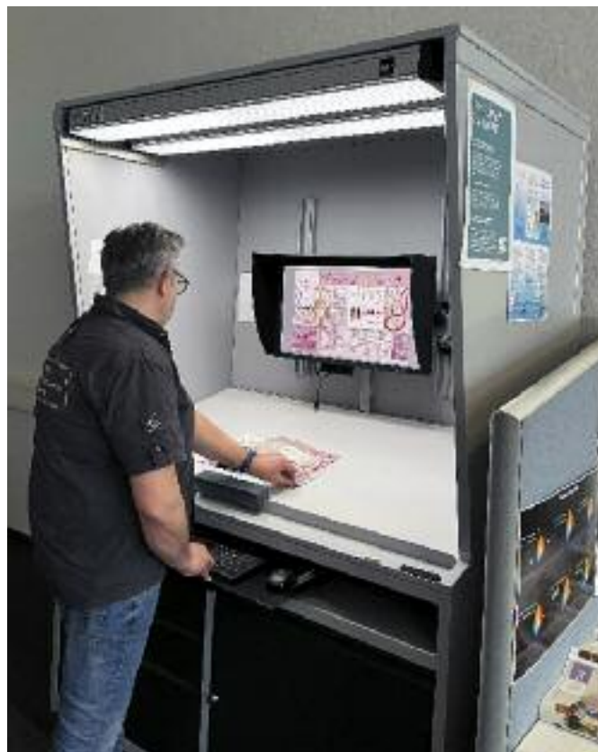
Die Burda Druck GmbH hat ihre 18 leuchtstoffbasierten Virtual ProofStations mit den DLS Upgrade Lösungen von Just Normlicht aufgerüstet, und damit die Anforderungen der neuen RoHS-Richtlinie umgesetzt.
