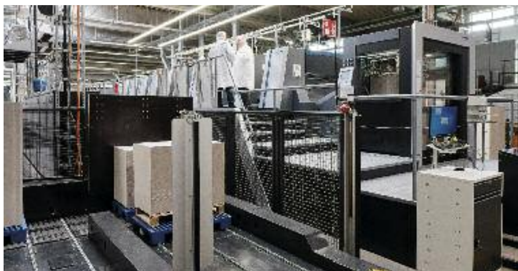
Weig Packaging hat seine Kapazitäten durch eine Speedmaster XL 106 21k , die erste Maschine der 21.000er-Generation in Deutschland, verstärkt. Die hochgesetzte Bogenoffsetmaschine ist mit vollautomatischer Palettenlogistik ausgerüstet.
