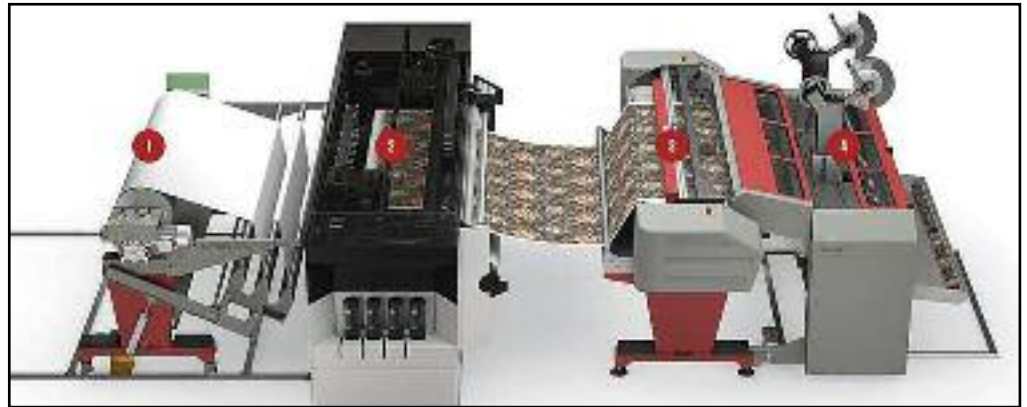
Die UVgel Wallpaper Factory ist eine vollautomatische Produktionslinie für digital bedruckte Tapeten und besteht aus Abrollereinheit, Drucker, Konfektionierer und Ausgabereinheit.
