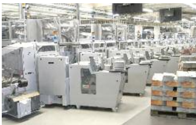
Dank der von Ferag realisierten neuen Linie aus EasySert Einstecktrommel, FlyStream Zusammentragstrecke und 23 Anlegern konnte Badendruck innerhalb kürzester Zeit die Produktionsdauer spürbar reduzieren und den Nettoausstoß der Beilagenproduktion am Standort Karlsruhe-Neureut signifikant steigern.
