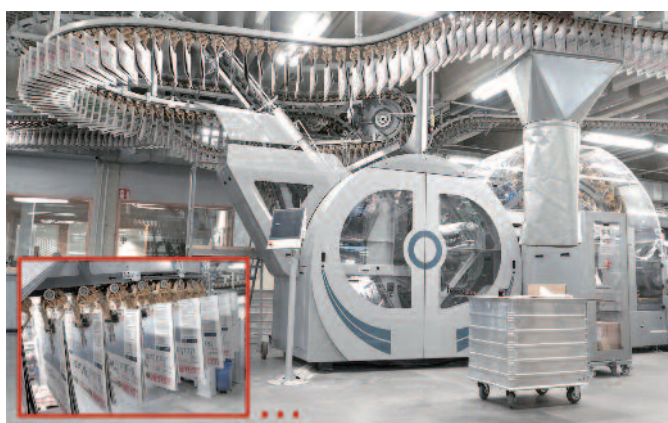
Nach dem von Ferag entwickelten Konzept können alle von Badendruck eingesetzten Kreuzleger beliebig den Versandraumstrecken zugewiesen werden. Um ein Höchstmaß an Flexibilität zu erreichen, wurden die bisher für den Abtransport eingesetzten PKT-Strecken zu einer »Acht« verbunden.
