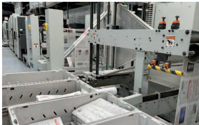
Die geringe Makulaturquote wird nicht durch die Inkjet-Maschine, sondern durch Besonderheiten der Weiterverarbeitungstechnik verursacht.
