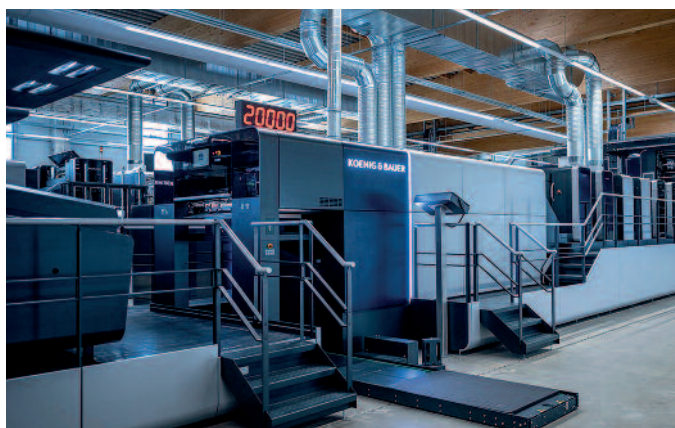
Die Rapida 106 X produziert mit Leitungen bis zu 20.000 Bogen/h. Mit ihren umfangreichen Automatisierungslösungen ist das Spitzenprodukt für den Bogenoffset der Zukunft
