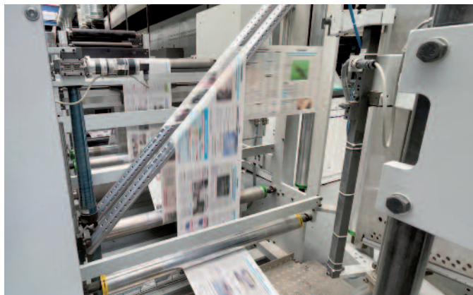
Die Prosper 6000C ist im Schnitt elf Stunden pro Tag im Einsatz, wobei sie mit einer Geschwindigkeit von 280 m/Min. bei 600 x 600 dpi Auflösung betrieben wird.
