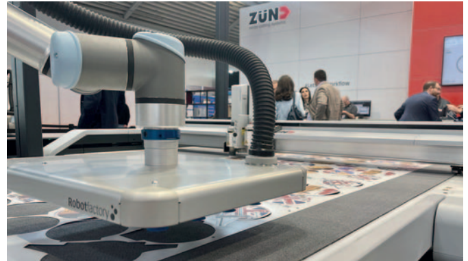
Zünd wird den Robot PortaTable 130 des Partners Robotfactory zeigen, der aus einem mobilen Ablagetisch und einem Roboterarm besteht.
