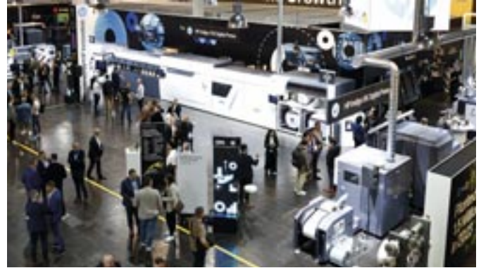
Die HP Indigo V12 ist ein digitales Schmalbahnsystem für den Etikettendruck und liefert bis zu 120 laufende Meter pro Minute.
