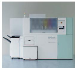
Mit der von *Epson* entwickelten *Dry Fiber-Technologie* wandelt das *PaperLab A-8100* gebrauchtes Büropapier in hochwertige Fasern um, ohne dass Wasser benötigt wird.
