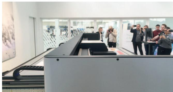
Der Flachbettdrucker *Nyala 5* lässt sich von beiden Seiten bedienen. Während im rechten Teil gedruckt wird, kann der Drucker auf der gegenüberliegenden Seite mit Material bestückt werden.
