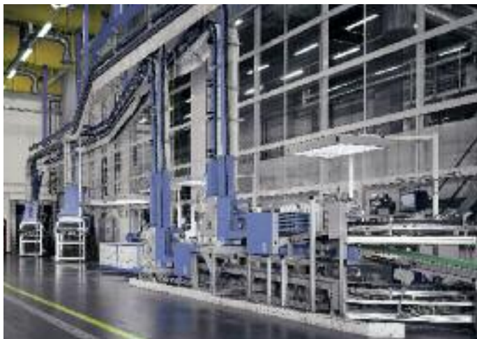
Das flurfreie Transportsystem Newsveyor bietet Layoutflexibilität und gute Zugänglichkeit für eine optimale Logistik mit großen Papiermengen.
