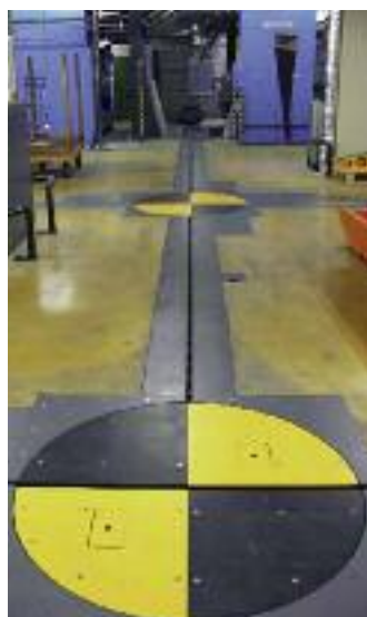
AUROload von manroland kann Rollen bis zu einem Durchmesser von 1.500 Millimeter verarbeiten.
