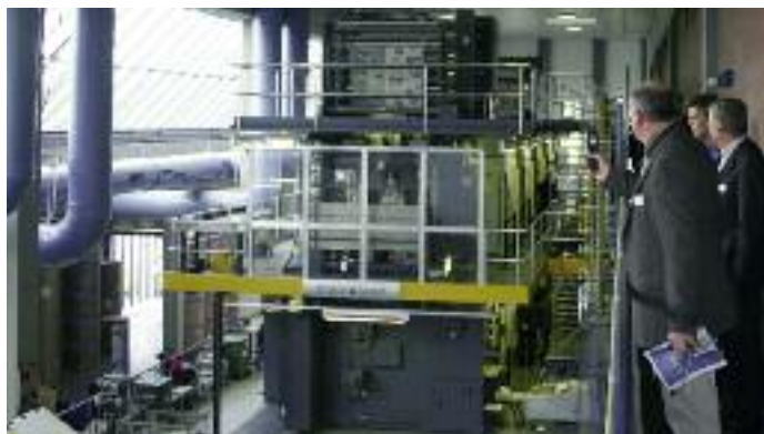
Die Drucktürme der Colorman autoprint sind mit 5,70 m Höhe deutlich niedriger als es die der vorherigen Zeitungsmaschine in Osnabrück waren.
