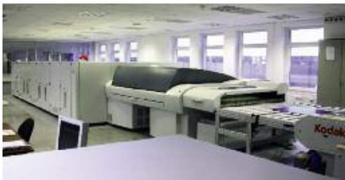
Der Kodak Magnus VLF Quantum Plattenbelichter wird vom automatischen Kodak Palettenlader (links) kontinuierlich mit Druckplatten versorgt.
