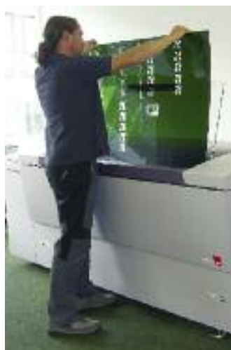
Für Geschäftsführer Peter Hamm ist das Flexcel NX System eine geeignete Lösung zur Steigerung der Qualität im Verpackungsflexodruck. Der Träger wird im Trendsetter NX mit der Kodak Squarespot-Technologie bebildert.
