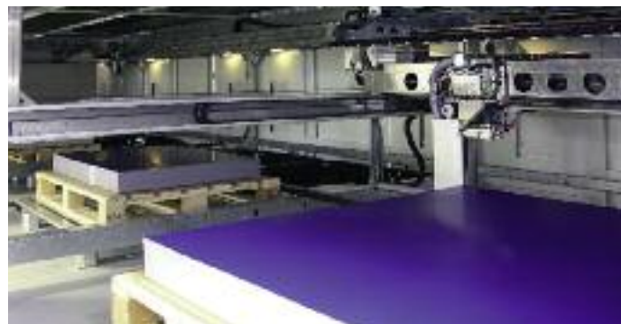
Der Palettenlader führt dem Belichter die Druckplatten direkt von den Lieferpaletten zu. Auf einer Palette befinden sich 600 (0,3 mm Stärke) bzw. 300 (0,4 mm) Platten.
