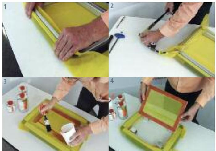
Siebspannungen bis ca. 30 N/cm sind mit wenigen Pumphyben einer gängigen Handpumpe erreichbar. Der Luftdruck dient als Referenzwert zur erzeugten Spannung. Einmal ermittelt, kann er direkt auf einem Manometer in »bar Luftdruck« abgelesen werden. Verliert das Gewebe nach einem üblichen Gebrauchszyklus an Spannung, so kann es einfach wieder gespannt werden. Eine Neuanfertigung eines Siebrahmens erübrigt sich daher.
