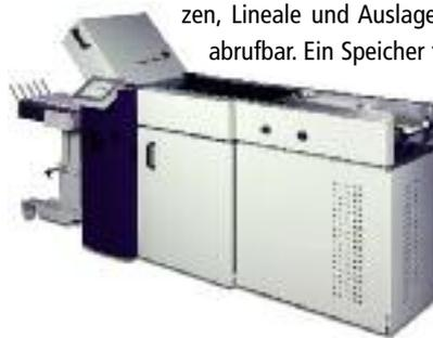
Jobs ermöglicht das Einrichten von Wiederholaufträgen in kurzer Zeit. Einlesbare Barcodes stellen die Maschine anhand der vorgegeben Auftragsdaten selbstständig ein. Zudem ist die Maschine mit einem Softwaremodul zur Fernwartung ausgestattet.
