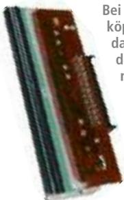
Bei Real-Edge-Druckköpfen befindet sich das Heizelement an der Kante des Trägermaterials und ermöglicht dadurch einen Druckprozess, bei dem das zu bedruckende Material nicht gebogen werden muss.
