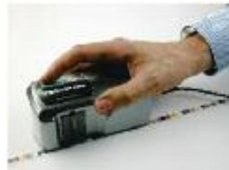
sensor ausgestattet, der über einen einschwenkbaren Polarisationsfilter verfügt, wie es die ISO-Normung vorgibt. Die Messdaten können in andere Softwareprogramme exportiert werden.
