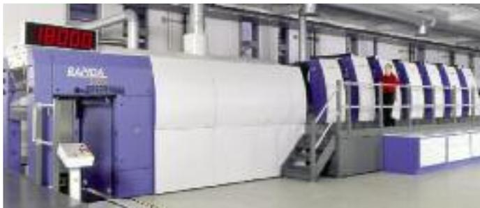
der Maschine mit KBA Plate-Ident sowie KBA Flying Job Change für paralleles Drucken und Rüsten und den unterbrechungsfreien Auftragswechsel. Hinzu kommt ein Lackturm mit vom Leitstand steuerbarer viskositätsorientierter Lackversorgung, automatischer Reinigung des Lackkreislaufs und automatisiertem Lackplattenwechsel. Die mit Karton- und Dünndruckpaketen ausgestattete Rapida 106 wird ihre Leistung bei Jobs auf Papier und Karton demonstrieren.
