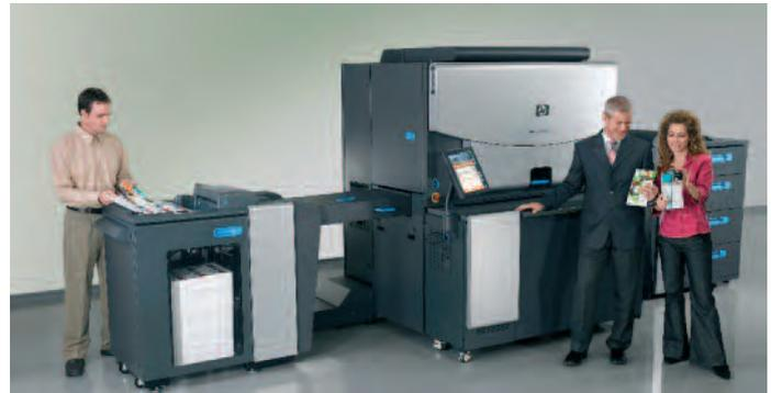
Die HP Indigo 7000 Digital Press, die auf der drupa Premiere feiert, erreicht mit 120 A4-Seiten pro Minute im Vierfarbmodus hohe Produktionsgeschwindigkeiten und eignet sich damit für Aufgaben im Akzidenzdruck, Direktmarketing, für Foto-Produkte sowie den Bücher- und Illustrationsdruck.
