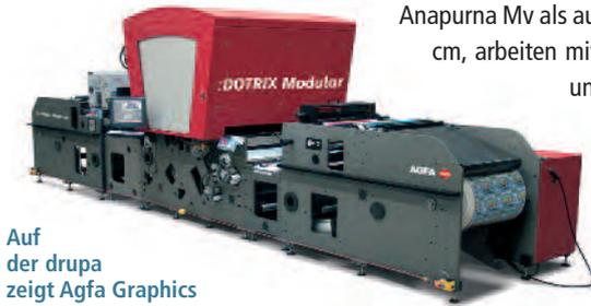
Auf der drupa zeigt Agfa Graphics das industrielle Inkjetdrucksystem Dotrix Modular in zwei Konfigurationen: eine für den Druck von flexiblen Verpackungen und eine für die Herstellung von Faltschachteln.
