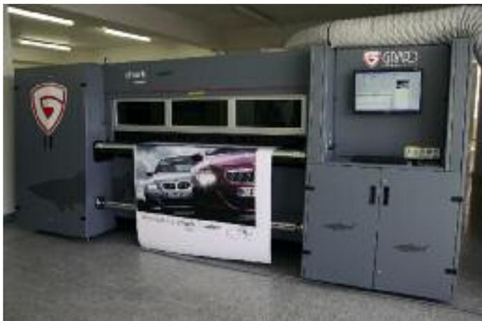
gewicht zuführen und verarbeiten kann. Die Produktionsgeschwindigkeit reicht von 40 m<sup>2</sup>/h für POS-Anwendungen in höchster Qualität bis hin zu 120 m<sup>2</sup>/h für Displays für den Außenbereich.
