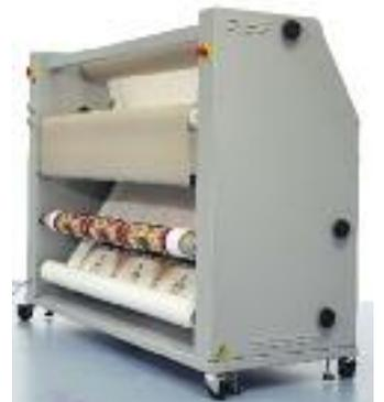
Der UniFixer 65 kann für den Hitzetransfer von Papierdrucken, die mit Mutohs wasserbasierenden Sublimationstinten erstellt wurden, auf Polyestergerewebe genauso verwendet werden wie für die Thermofixierung von vorgedruckten Stoffen, die mit wasserbasierenden Farbstoffdirekttinten produziert wurden. Der schnelle Hitzetransfer wird möglich durch eine ölfreie Drehwalze mit integrierter Quartzinfrarotlampe.
