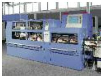
sowie für Produkte mit großen Dicken. Die von Müller Martini patentierte variable Frontschnitt-Technologie bietet mehrere Vorteile, unter anderem reduzierte Einrichtzeit, an das jeweilige Produkt angepasste Variabilität der Produktbreite von bis zu 30 mm und genaue Buchformate auch bei großen Seitensprüngen (+/- 100 Seiten).
