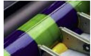
nung im Farbkasten. Der Begriff Iris kommt aus dem Griechischen und wird auch Regenbogenhaut genannt. Beim Iris-Druck laufen die unterschiedlichen Farben in einem Farbkasten zu feinen Linien kontrolliert auf dem Bogen zusammen. Der so entstehende Farbverlauf innerhalb des Drucksujets ist die Voraussetzung für den so genannten Sicherheitsdruck.
