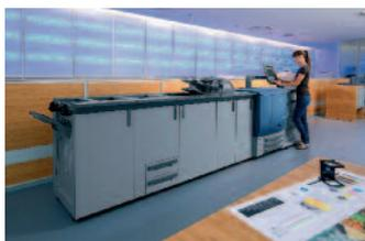
C6501e. Die Kürzel C6000 und C7000 stehen für 60 beziehungsweise 71 Bögen pro Minute. Verarbeitet werden Medien von 64 bis 300 g/m<sup>2</sup>. Mit der neuen Bildtechnologie S.E.A.D. II («Screen-Enhancing Active Digital Process») erzielen die Systeme bei einer Farbauflösung von 1.200 x 1200 dpi bei 8 bit eine sehr hohe Farbstabilität und Präzision.
