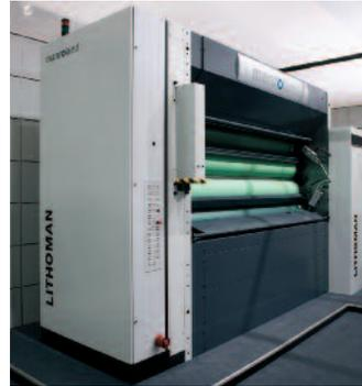
wird Rotooffset im kommenden Jahr weiter Fahrt aufnehmen. 90% der weltweit installierten Maschinen mit einer Bahnbreite von über zwei Metern hat manroland entwickelt und gebaut. Die Lithoman S mit 2,86 m Bahnbreite ist mit einem Rollenwechsler, vier Doppeldruckwerken und zwei Falzwerken ausgestattet.
