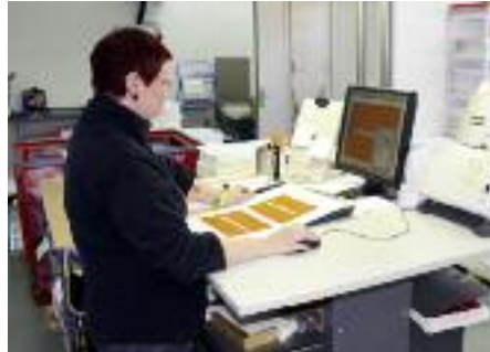
Letzte Überprüfung eines Digitaldruckjobs am Kodak NexPress Front End vor der Produktion.
