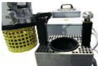
Schmelzplatte und einem beheizten Schlauch übernimmt die Vorschmelzeinheit komplett die Versorgung der Düse mit PUR-Klebstoff. Die eigentliche Dosierung der Klebstoffmenge und deren Auftrag auf den Buchblock erfolgen direkt im Düsenkopf.
