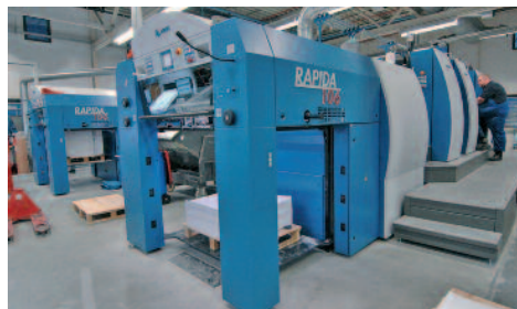
Die vier Rapida 106 mit Flying Job Change für den nahezu unterbrechungsfreien 2/2-Druck kleinerer Buchauflagen bei Ten Brink/Hooiberg Haasbeek sind in einen durchgehenden JDF/JMF-Workflow integriert.
