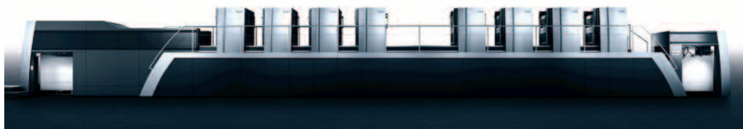
Die Großformatmaschine von Heidelberg – hier die Speedmaster XL 162-Achtfarben – ist nun auch als Wendemaschine erfolgreich in der Produktion beim Kunden angelaufen.
