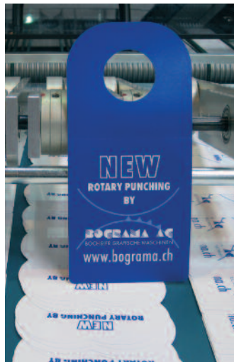
Innenstanzungen mit Abfallentsorgen, Auslegen mit Stapel- oder Schuppenauslage.
