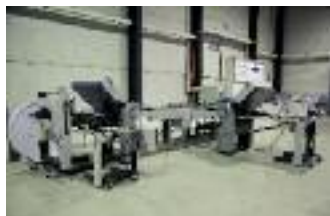
Stahlfolder-Falztechnologie für den digitalen Zeitungsdruck mit wahlweiser Broadsheet- und Tabloid-Verarbeitung.
