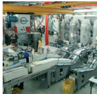
Die UniDrum ist mit sechs Anlegern ausgestattet. Die einzelnen Bogen werden in Stangen angeliefert, an der Trommel zusammengeführt sowie geheftet und im nächsten Schritt an der Schneidtrommel SNT-U beschnitten.
