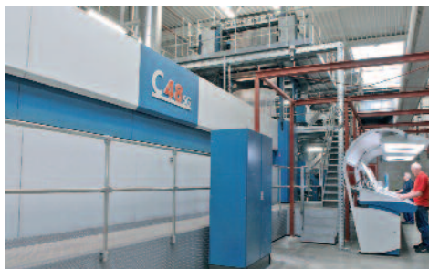
Die 48-Seiten-Rotation KBA C48 SG (SG= Short Grain) ist wie die im November 2010 bei L.N. Schaffrath vorgestellte 16-Seiten-Anlage C16 für schnelle Jobwechsel weitgehend automatisiert.
