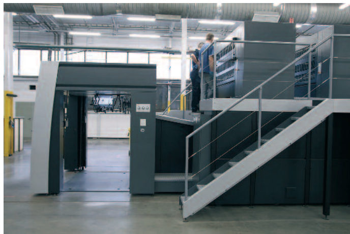
Die Druckerei QuadWinkowski nahm kürzlich eine Speedmaster XL 162 Fünffarben mit Lackierwerk im Werk Radzymin in der Nähe von Warschau in Betrieb.
