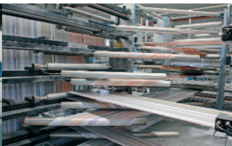
Der Wendestangenüberbau erlaubt in Verbindung mit dem P5-Greiferfalzapparat sowie Strang- und Lagenheftapparaten eine hohe Produktflexibilität.
