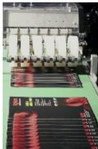
PhotoSlit kann bis zu 8.000 SRA3-Bögen pro Stunde verarbeiten.
