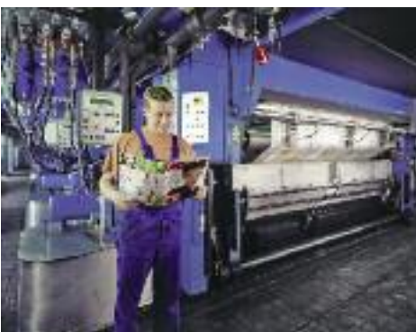
1996: Illustrations-Tiefdruckrolle KBA TR 10B mit 3,60 m max. Bahnbreite für Sebald-Druck (jetzt Burda Druck) in Nürnberg.
